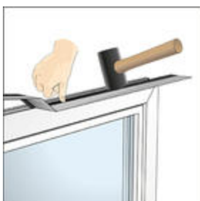
Afb. 3: Het geschikte profiel met rubberhamer aanbrengen.
